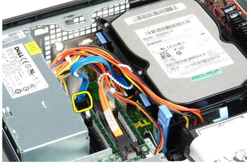
4. اضغط على ألسنة التثبيت زرقاء اللون الموجودة على كل جانب من جوانب مجموعة محرك الأقراص الثابتة، ثم ادفع المجموعة لأعلى وخارج الكمبيوتر.
