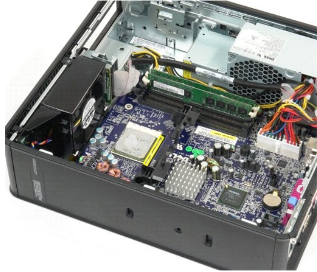
5. ارفع المعالج خارج الفتحة المخصصة له على لوحة النظام.
