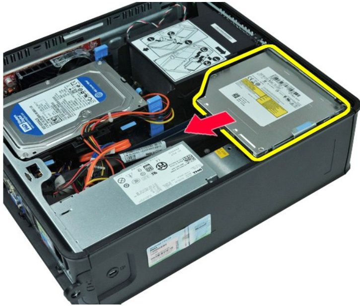
5. ارفع محرك الأقراص الضوئية لأعلى وخارج الكمبيوتر.
